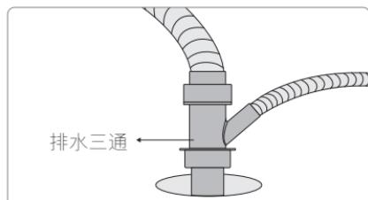
② 排水管插入地漏内一定深度
