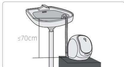
① 将排水管连接到机器排水口上，用排水管卡簧将其固定。
